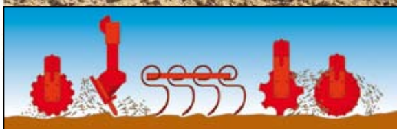
SCHEMA DE SUCCESIUNI: Lamă nivelatoare, Rulou anterior, Dinți Denti a molla e Rulou posterior
